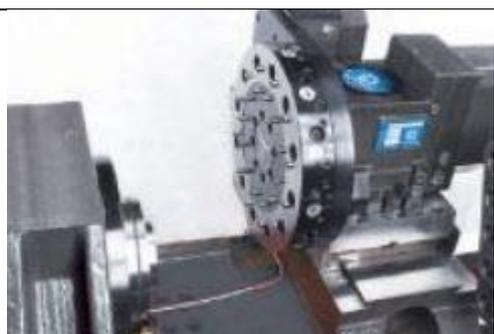
12-ти позиционная револьверная головка с приводным инструментом для ста
