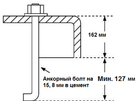
Схема крепления основания анкерными болтами
