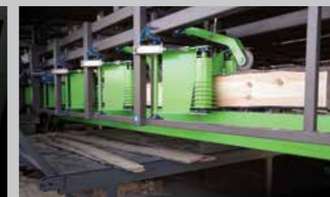
Авт. разгрузка с отделением досок и отходов
