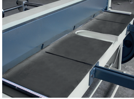
Döküm Taşlanmış tabla Cast Iron ground Table
