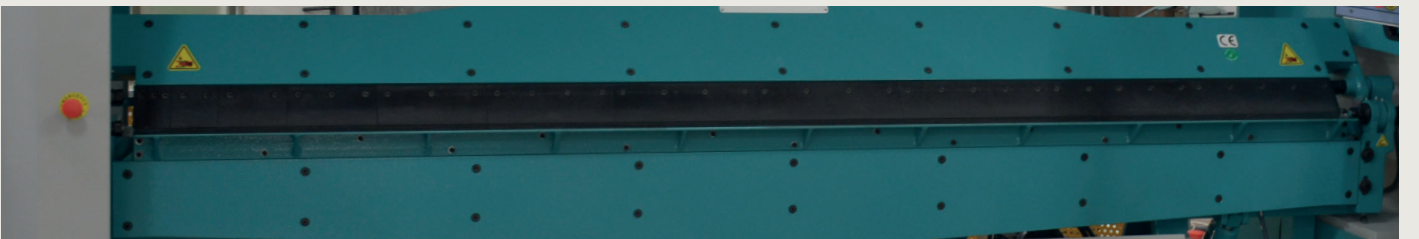
Tam Boy Arkor Kaplamalı sertleştirilmiş parçalı bıçaklar / Full Length Arcor Nitrocarburized hardened segmented blades
