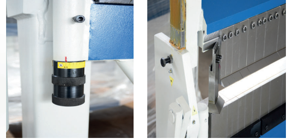
Alt ve Üst Bıçaklar Parçalı Pabuç tip Top & Bottom Blades Both Segmented Shoe Type
