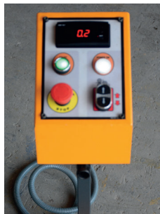
Opsiyonel dijital kontrollü bükme açısı Optional digital read cut angle setting
