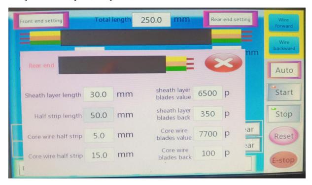
Настройки для заднего конца провода такие же, как и настройки переднего конца провода.
