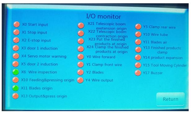
Каждая точка контроля ввода - вывода соответствует точкам подключения на материнской плате, и обычно они позволяют контролировать и определять проблемы в работе машины.
