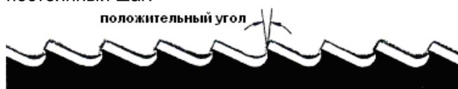
Может использоваться для поперечных и диагональных распилов различных сечений или широких труб, но основное применение – резка твердых материалов (высоколегированных и нержавеющей сталей, специальной бронзы и серого чугуна)
