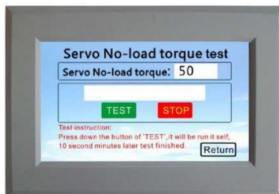
Рисунок 5. Испытание крутящего момента сервопривода без нагрузки
