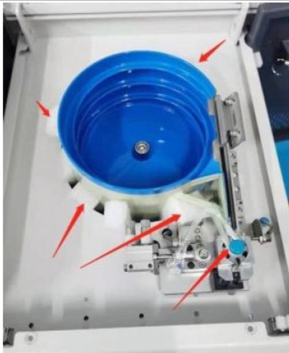
Выньте машину, и прежде чем машина проветрится и будет включена, необходимо снять жемчужную вату и связующую веревку, закрепленную вибрирующей пластиной. Как показано на рисунке выше, в то же время проверьте, отклонена ли вибрационная пластина, поскольку вибрационная пластина может отклоняться во время процесса логистической вибрации.
