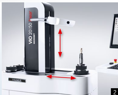
1: Дополнительная камера для настройки положения центра вращения (опция)/Second camera for measuring the centre of rotation (optional) 2 + 3: Полностью автоматизированный осевой привод благодаря линейной технологии/Fully automatic axis drive via modern linear technology
