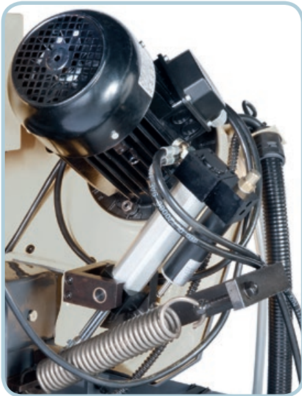
Bajada hidráulica (K-300/2-M-BH) Hydraulic descent (K-300/2-M-BH)
