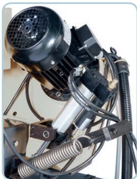
Bajada hidráulica (K-300-M-D/I-BH) Hydraulic descent (K-300-M-D/I-BH)
