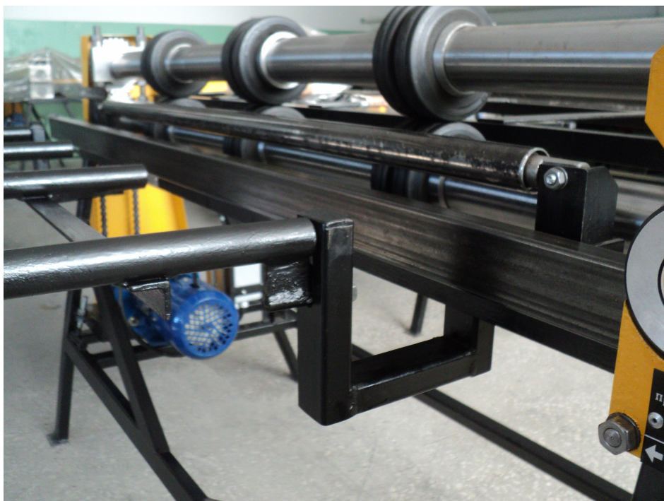
На фото: кронштейны крепления приёмного стола к станку ПРЭМ.
