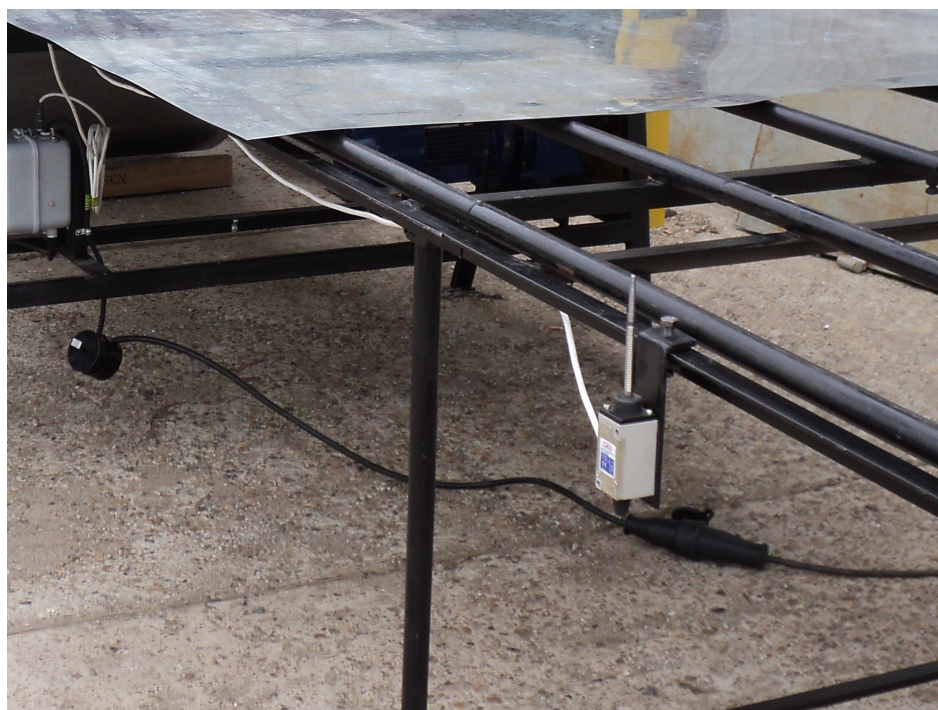
На фото : вид установки конечного выключателя на приёмном столе.
