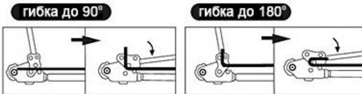
Рис. 1: Пример гибки арматуры до 90° и 180°.
