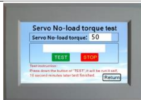
Рисунок 5. Тестирование крутящего момента сервопривода без нагрузки
