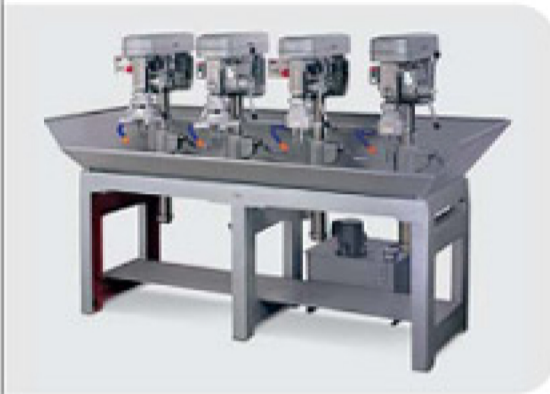
Gang Type Coolant Tray 聯立擋水座
