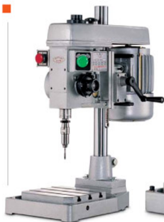
KST-203A Fully Automatic Tapping Machine 全自動攻牙機
