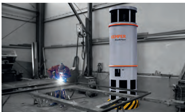
22 Фильтровентиляционные системы цехов и помещений
