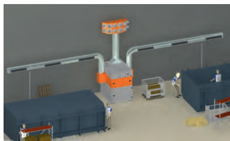
Производительность вытяжной системы: 9.000 м 3 /ч
