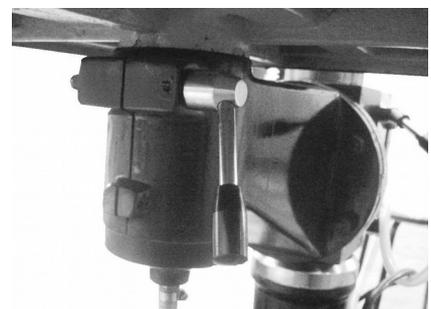
Для поворота стола в горизонтальной плоскости отпустите зажимное устройство поворота стола, расположенное снизу стола (см. рис. 12.). Поверните стол в горизонтальной плоскости на требуемый угол. Зажмите стол в новом положении.
