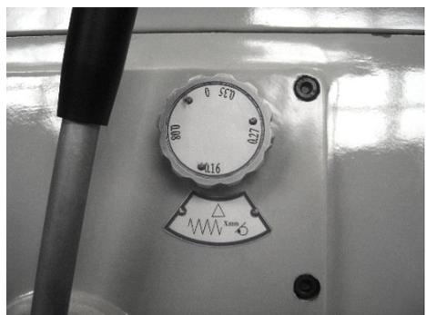
Скорость механической подачи шпинделя устанавливается с помощью маховичка, расположенного на правой стороне шпиндельной головки. Вращая маховичок можно установить одну из четырёх имеющихся на станке подач
