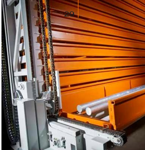
Грузовая траверса с кассетами для прутков.
