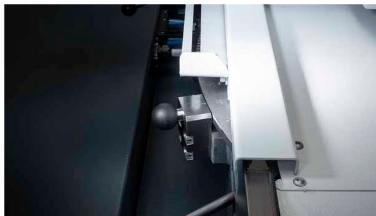
Плавная регулировка угла направления заготовки.
