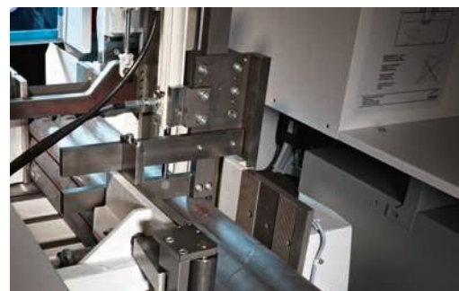
Гидравлический пакетный прижим на стороне входа.
