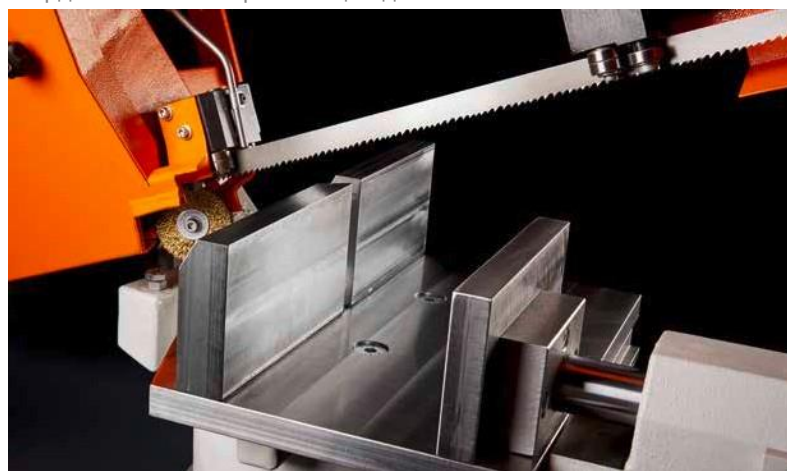
Радиальные шарикоподшипники, закрытые с обеих сторон и твердосплавные направляющие для ленточной пилы.
