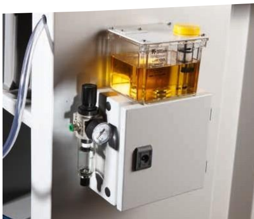
Микро-струйная система смазки.
