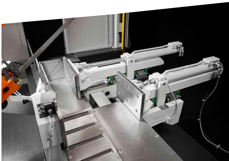
Подача через шарико-винтовую пару, плавно регулируемый угол реза.
