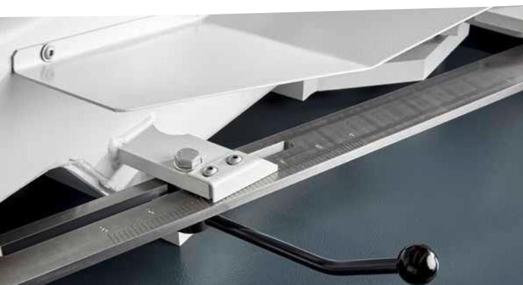
Плавно регулируемый угол реза.
