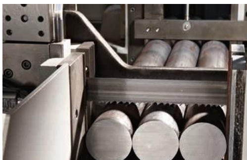
Гидравлический пакетный прижим на стороне выхода.
