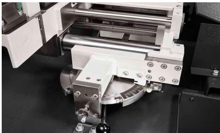
Подача через шарико-винтовую пару, плавно регулируемый угол реза.
