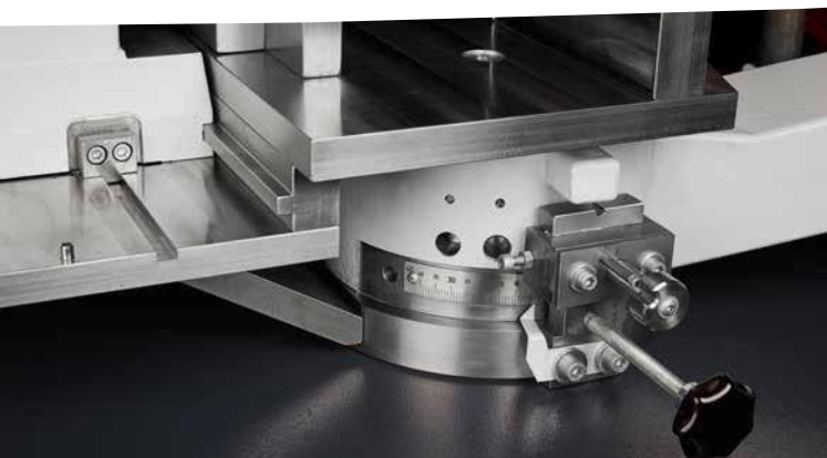
Горизонтальный тисок с быстросъемным рычагом.
