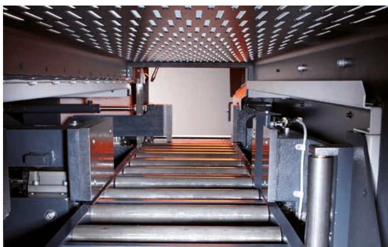
Зажимное устройство на линейных направляющих.
