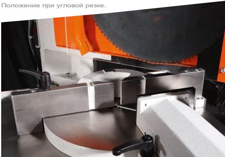
Зажимные тиски с противозажимом для резки без заусенцев.
