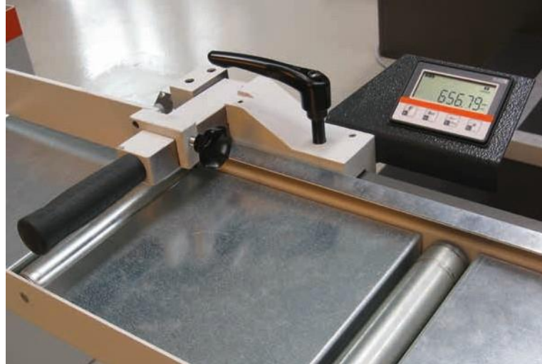
Цифровой измерительный стопор KASTOexact D 150.
