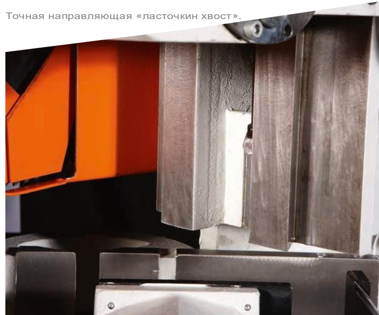
Полуавтомат, пневматическое зажимное устройство.
