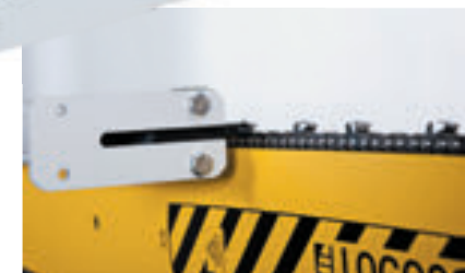
Стабилизатор верхушки шины увеличивает точность.
