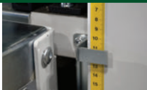
Быстрая настройка при использовании двух шкал настройки.
