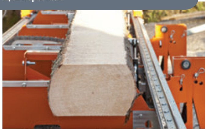
Ствол обрезается с двух сторон, например, на ленточной пилораме. Таким образом, создается лафет, который затем распиливается на доски на Локсе.
