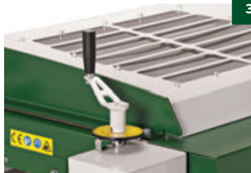
Пластина показывает размер до 0,1 мм.
