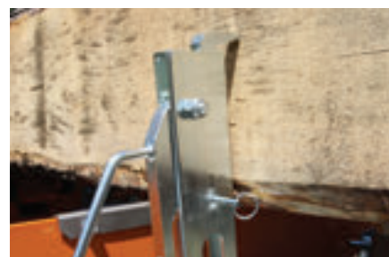
Мощные зажимы ствола с эксцентрической фиксацией.
