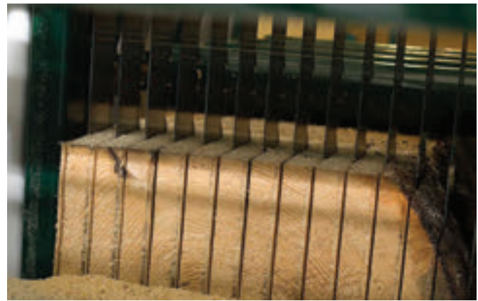
Наш рамный многопил всегда дает отличное качество. Вы можете заточивать пильные полотна не чаще, чем перед каждой второй сменой.
