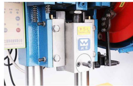
每台机器都经过公司特别研发的“滑块平衡度 调节装置”安装调试，再通过精确百分表测量， 以保证滑块水平平衡度。
