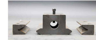
滑块体和两侧轨道统一编号， 一体加工，配合度更高，平衡 度精度更好。
