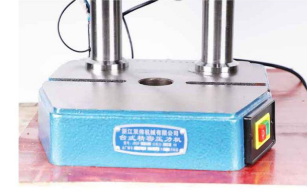
底座磨床精磨，同时配合滑块底面做平衡度调节，保证冲 压产品的精度。
