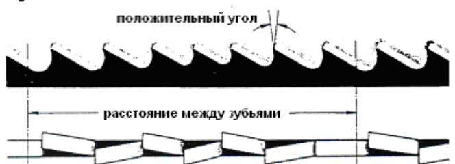
Этот тип полотна наиболее пригоден для резания сортового профиля и толстых
