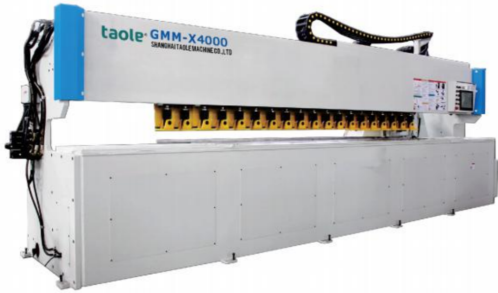
高效坡口作业 0~1200mm/min PROCESSING SPEED
