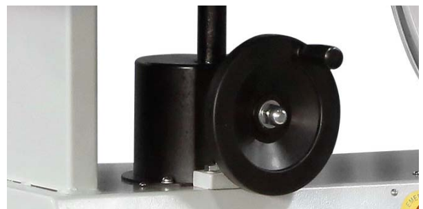
Рис.7: Регулировка высоты стола
