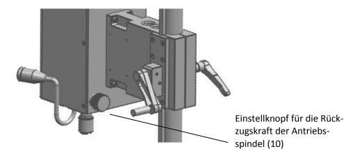
Mit dem Einstellknopf (10) auf der Rückseite der Maschine lässt sich die Rückzugskraft der Antriebsspindel einstellen.
