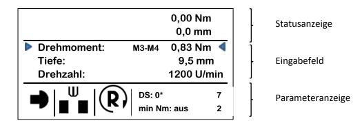
Das Arbeitsmenü ist in drei Bereiche unterteilt. Der obere Bereich zeigt die erreichten Werte des letzten Bearbeitungsvorgangs sowie mögliche Statusmeldungen. Der mittlere Bereich ist das Eingabefeld zur Einstellung des Drehmoments, der Tiefe und der Drehzahl. Im unteren Bereich erscheint die Anzeige der eingegebenen Hauptparameter.
