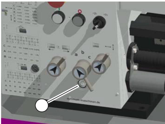
Смотровое стекло для проверки уровня масла в механизме подачи
