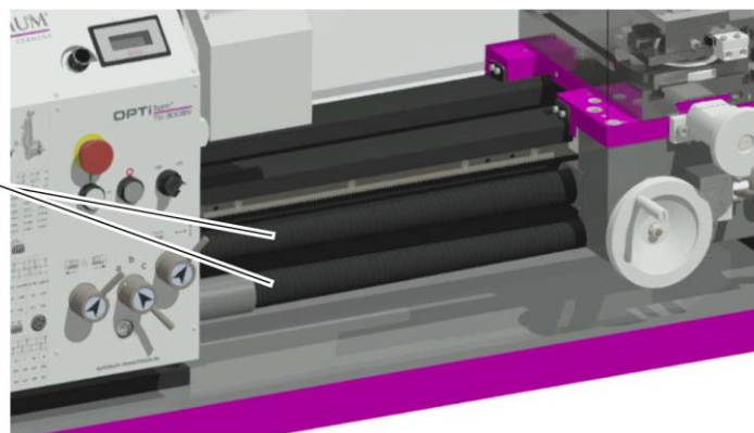
Рис. 1-4: Ходовой винт и тяга механизма подачи с защитной крышкой
