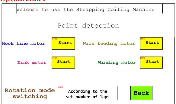
Этот интерфейс предназначен для ручного запуска электродвигателей в случае неисправности станка (позволяет определить ее причину).
