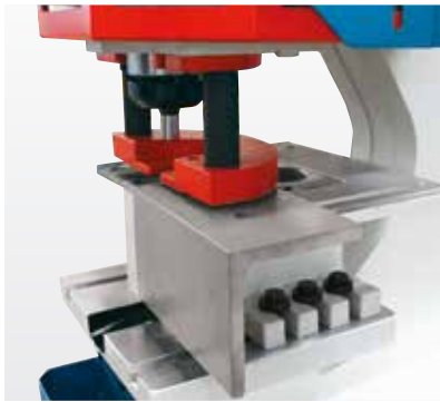
Перфорационная станция с большим опорным столом
