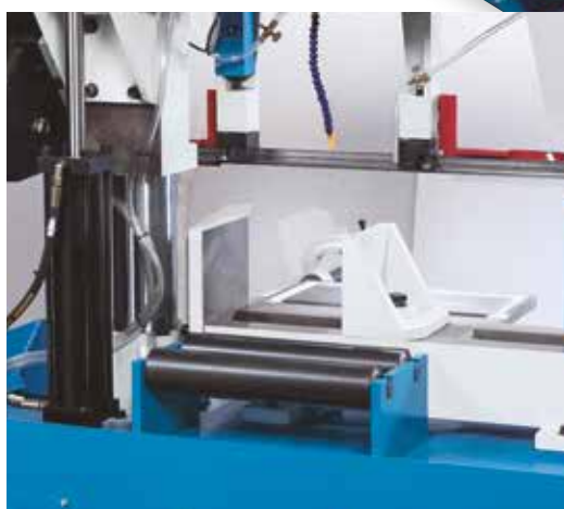
Роликовая опора для упрощения подачи материала
