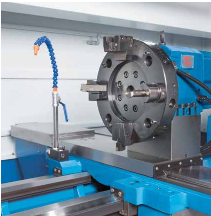
Поворотный механизм VDI на 8 инструментов для внутренней и внешней обработки
