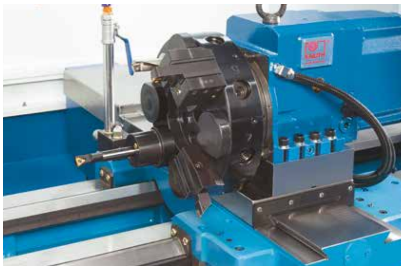
Инструментальная револьверная головка с восемью станциями VDI 30 (Numturn 420 SI)
