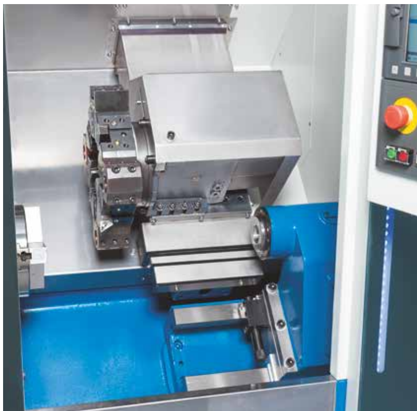
Инструментальный револьвер на 8 единиц
