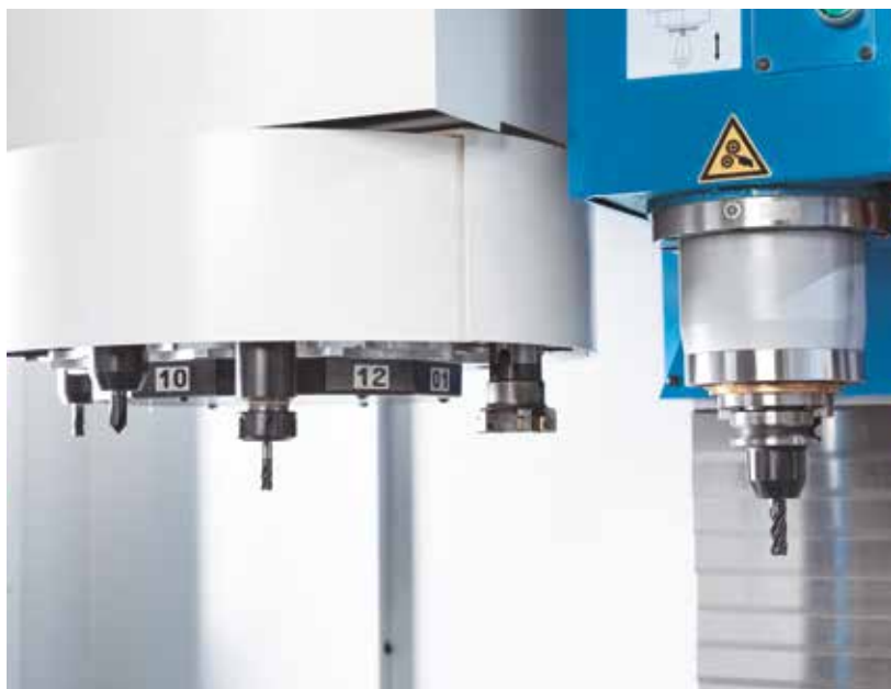
Надежное 12-позиционное горизонтальное устройство смены инструмента
