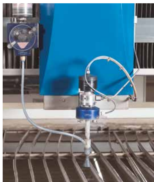
Режущая головка и абразивная система оптимально согласованы с соответствующей системой высокого давления. Насосы высокого давления BFT с режущей головкой ALLFI и абразивной системой (рис.)
