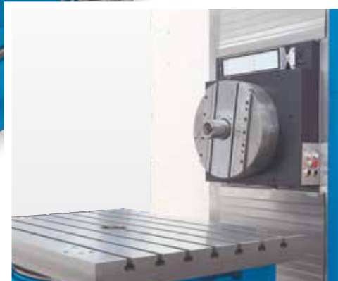
Зажимной стол с ручной регулировкой угла
