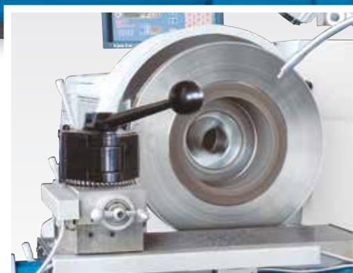
Постоянная скорость резания для идеальной поверхности
