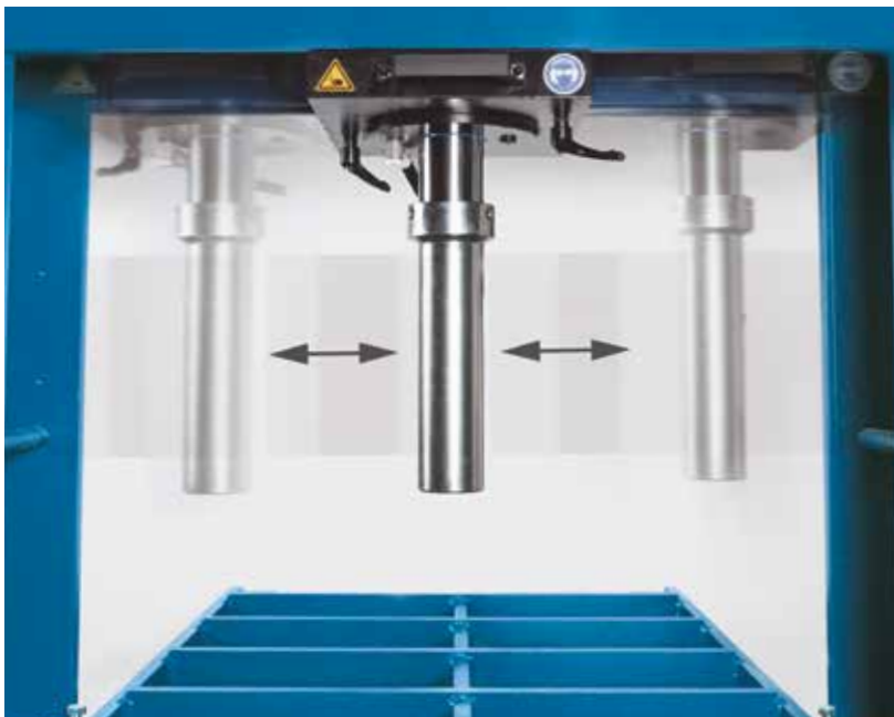
Рабочий поршень с боковым перемещением
