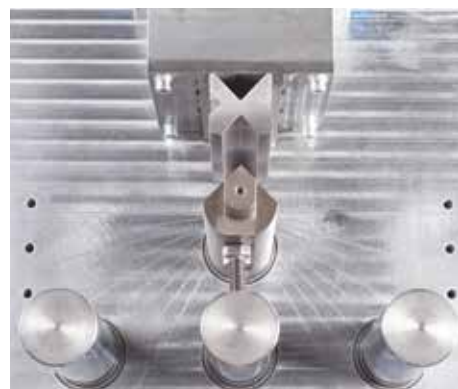
Угловые линии выгравированы на рабочем столе для ориентации
