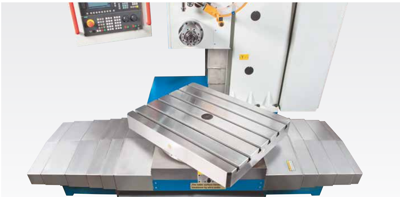
Рабочий стол с закаленной поверхностью, вращающийся на 360°
