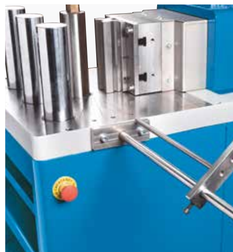
Перемещаемый вручную боковой упор для серийной обработки
