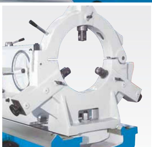
Неподвижный люнет с большим диаметром зажима
