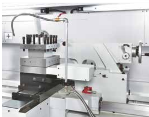
Простое управление: для позиционирования заднюю бабку можно соединить с суппортом
