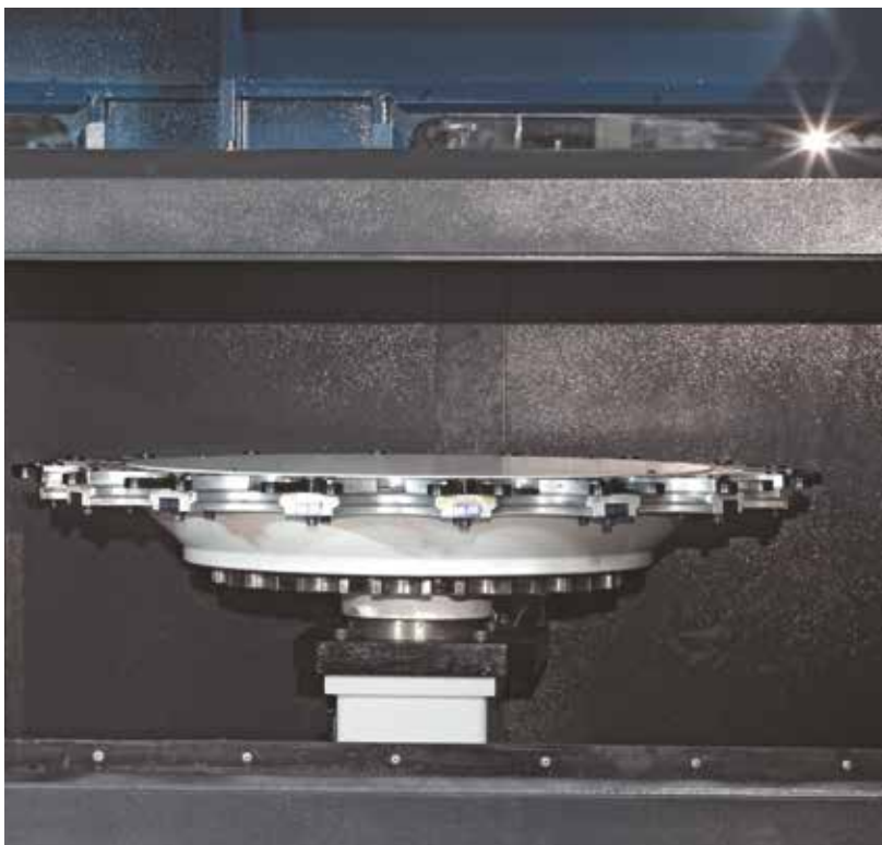
20-позиционный сменщик инструмента
