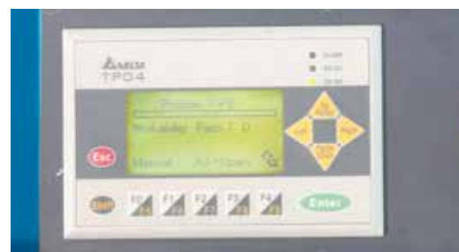
Параметры пруткового магазина вводятся на удобной панели управления
