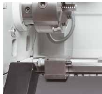
Микрометрический упор станины гарантирует высокую точность повтора
