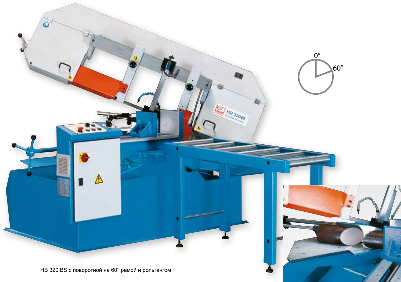
HB 320 BS: автоматический отвод рамы пилы по окончании распила
