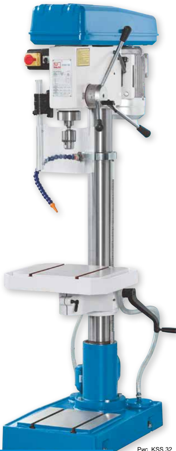
KSS 25V и KSS 32 • С системой охлаждения
