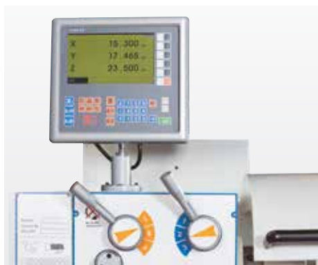
Устройство индикации координат для осей X, Z и Z1
