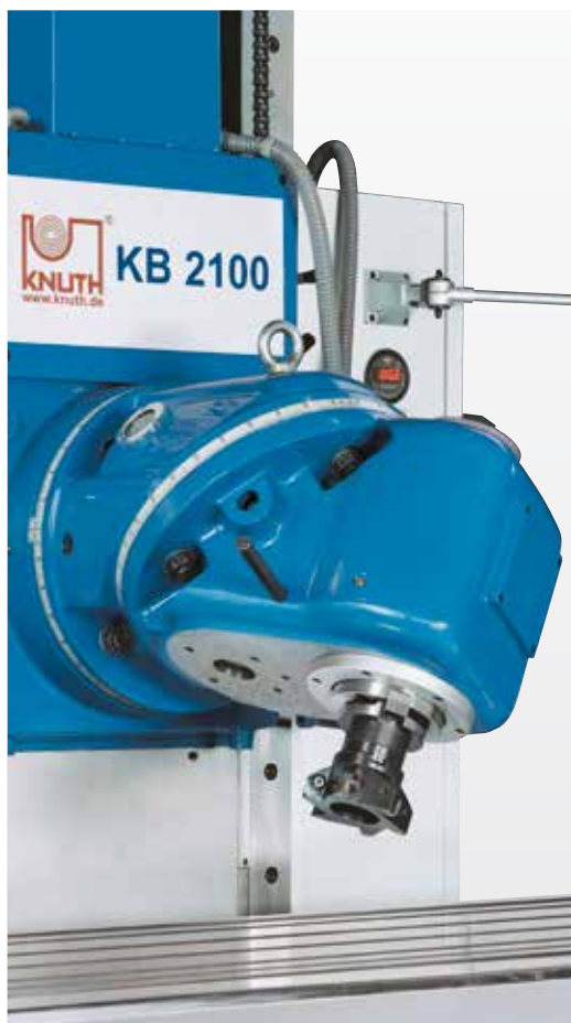
Регулировка с помощью 2-х плоскостей поворота под любым углом
