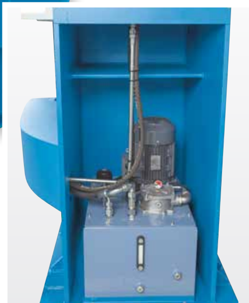
Компактный гидравлический блок интегрированный в основание станка
