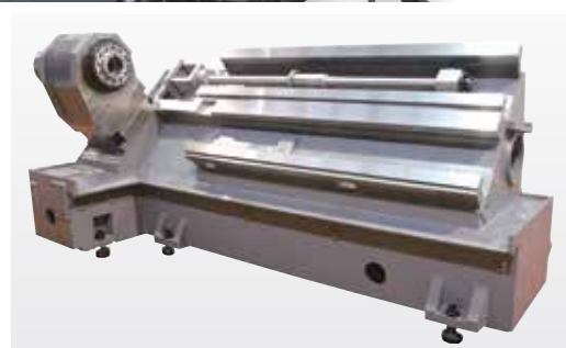
Тяжелая станина с закаленными и отшлифованными направляющими
