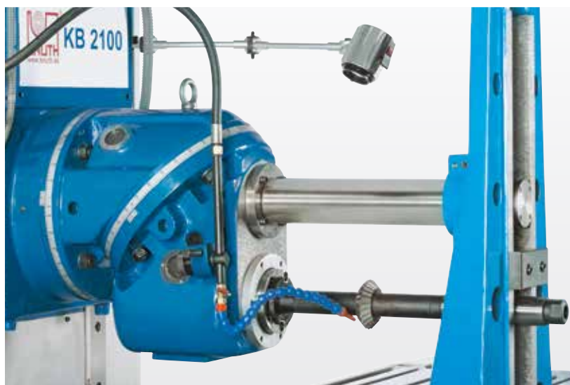
Стабильная система противодержателей для длинных фрезерных оправок
