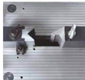
Гибочный пуансон перемещается по удлиненному и закаленному несущим направляющим, смазка на которые подается с централизованной системы смазки
