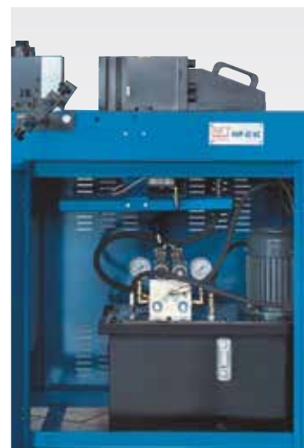
Компактный гидравлический блок расположен в основании и легко доступен
