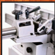
Параллельный упор с реечной передачей
