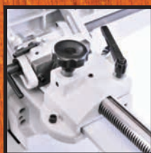
Параллельный упор с реечной передачей
