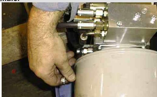
1. Отвинтить гайку регулировочного винта.
