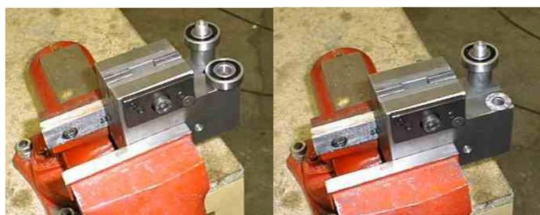
9. Вынуть эксцентрики из направляющего блока.
