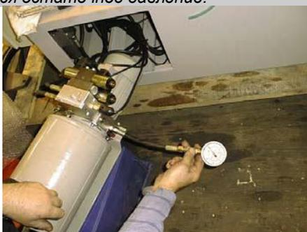
Отвернуть винт с блока насоса. Установить на место винта манометр (резьба G1/4") с диапазоном измерений от 0 до 60 бар.
