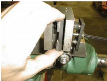
6. Теперь вставьте новые твердосплавные направляющие, и плотно затяните их винтом.
