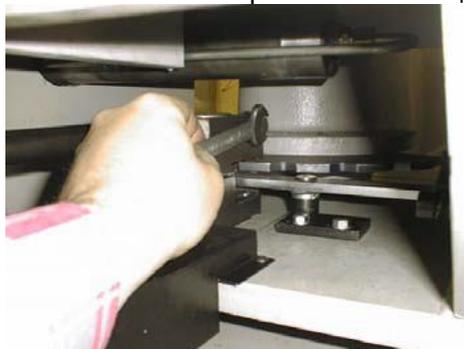
1. Ослабьте финт-фиксатор прижимного рычага. Теперь он может поворачиваться.
