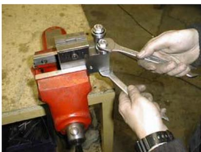
6. Закрепить направляющий блок в тисках и снять оба эксцентрика с подшипниками следующим образом.
