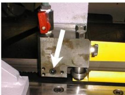
2. Прижмите направляющую к ленточной пиле, затянув три винта. Убедитесь в том, что она не мешает ходу ленточной пилы. Твердосплавная направляющая установлена правильно, если ход ленточной пилы свободный (между ленточной пилой и направляющей нет большого зазора).
