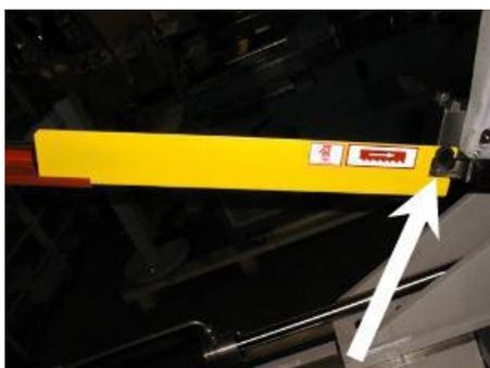
3. Снять левую крышку полотна пилы. Крышка фиксируется винтами с пластмассовой головкой.
