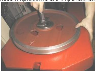
9. Установите колесо на вал и закрепите его винтом.
