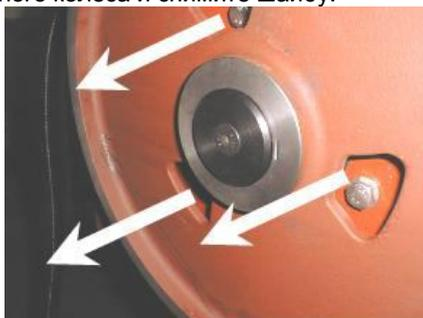
3. Снимите колесо с вала с помощью съемника с тремя захватами.
