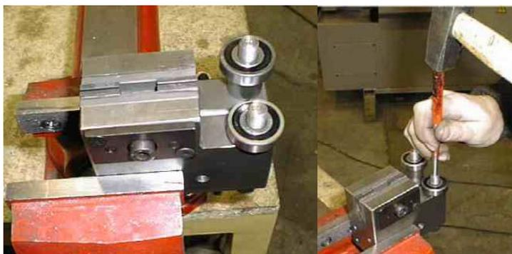
8. Вынуть эксцентрики из подшипников с помощью пробойника.
