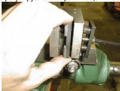
4. Отвинтите регулировочный винт регулируемой твердосплавной направляющей. Она должна отходить от направляющего блока настолько, что ее не было бы видно с внутренней стороны.
