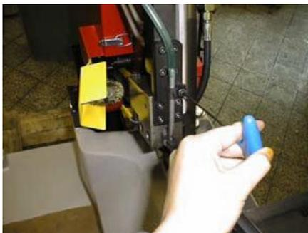
1. Отсоединить шланг для охлаждающей жидкости и демонтируйте ленточную пилу и направляющий блок пилы.
