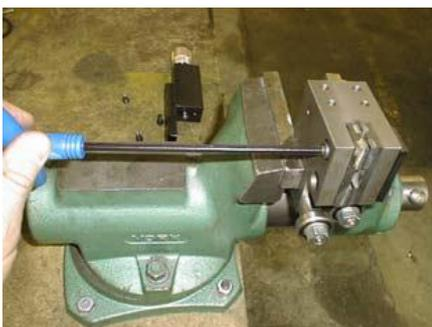
2. Зажмите направляющий блок в тисках и вывинтите винты из обеих твердосплавных пластин.
