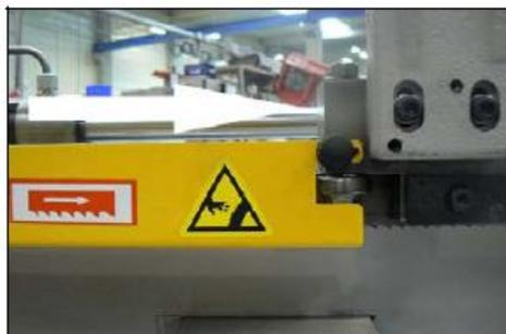
После успешного подключения станка кратковременно включить станок и переключить приводной двигатель пилы в рабочее положение. Направление должно соответствовать направлению стрелки на крышке ленточной пилы. Если направление движения пилы обратное, надо поменять местами две фазы на клеммной колодке.
