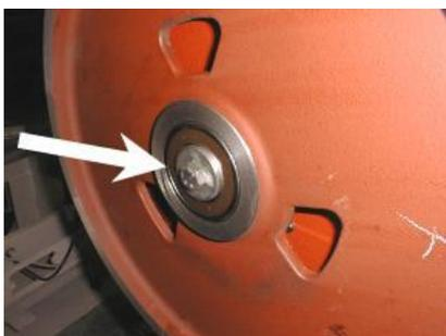
2. Отвинтить винт крепления натяжного колеса и вынуть шайбу.
