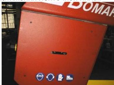
1. Снимите крышку устройства натяжения ленточной пилы.
