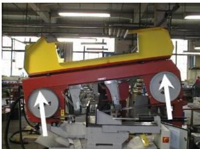
3. Накинуть ленточную пилу на оба направляющих колеса. Убедиться в том, что кромка ленточной пилы плотно прилегает к ободу колеса.
