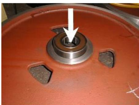
8. Вставьте подшипник в отверстие в колесе и прижмите его к крепежному кольцу.
