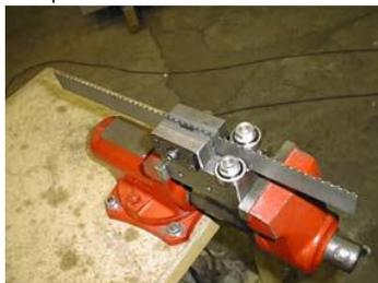
16. Вставьте в направляющей блок фрагмент ленточной пилы (15-20 см).
