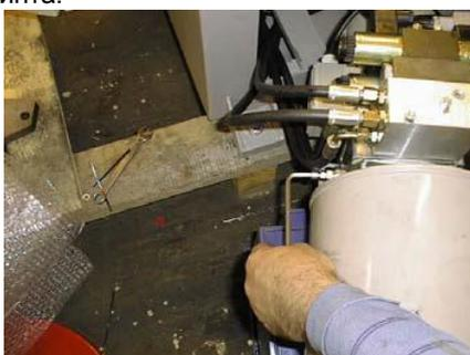
2. Установить давление с помощью регулировочного винта и манометра.
