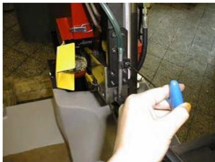
1. Отсоединить шланг для охлаждающей жидкости и демонтировать ленточную пилу и направляющий блок пилы.
