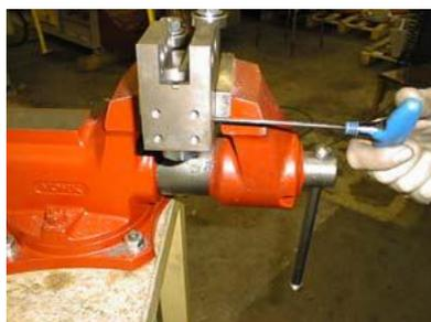
1. Закрепить направляющий блок в тисках с помощью ключа № 3, ослабить фиксирующий винт держателя подшипника.
