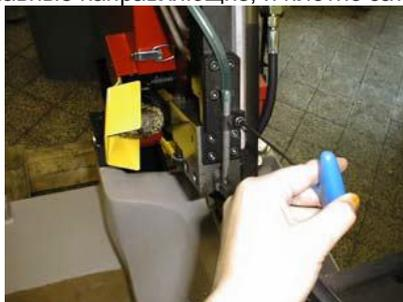
7. Установите блок в держатель и подключите систему охлаждения.
