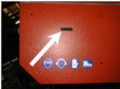
Ход ленточной пилы регулируется с помощью винта (см. стрелку) в натяжном блоке на раме пилы. Оптимальное расстояние составляет **1 мм**.
