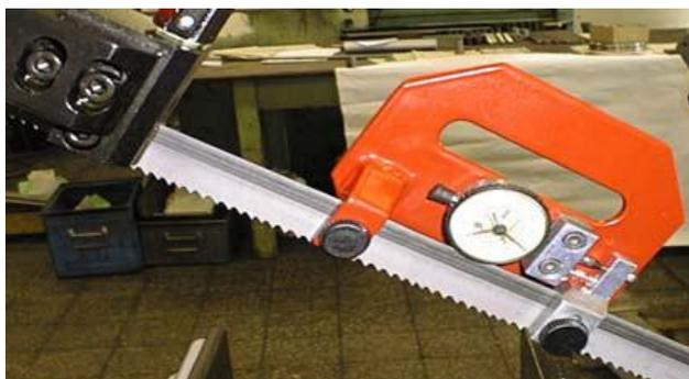
2. Установить Tenzomat на ленточную пилу и закрепить его винтами.
