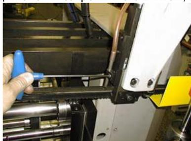
10. Установить блок на держатель направляющего блока, закрепить регулятор давления реза и подсоединить систему охлаждения.
