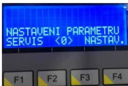
Нажмите клавишу F2 для установки 0 на экране отображения угла консоли.
