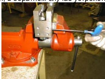
9. Установить держатель в направляющий блок и закрепить его винтом, пользуясь гаечным ключом.
