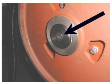
2. Вывинтите крепежный винт приводного колеса и снимите шайбу.
