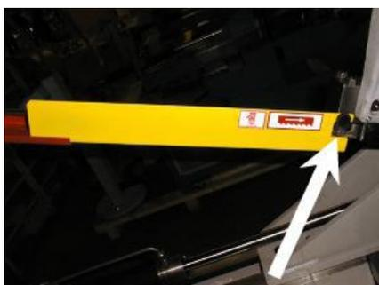
6. Установить левую защитную крышку полотна пилы.
