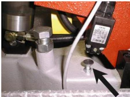
1. Ослабьте гайку зажимного винта и отверните зажимной винт.
