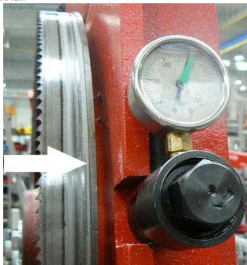
4. Проверить положение ленточной пилы на колесах.
