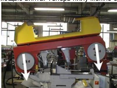
7. Снять пилу с колес.
