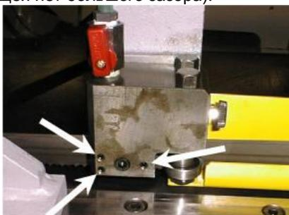
3. Затяните винт. Винт фиксирует направляющую в направляющем блоке. Убедитесь в отсутствии повреждений направляющей.
