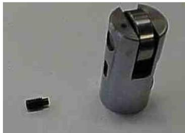
2. Снять держатель подшипника с направляющего блока.
