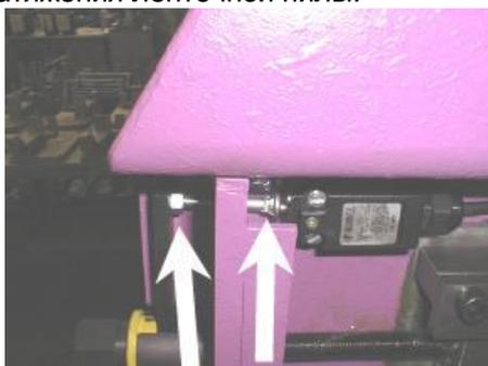
2. Отверните гайку и винт концевого выключателя.
