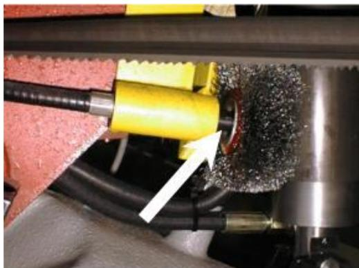
1. Ослабить гайку на щетке, заменить изношенную щетку новой щеткой, затянуть гайку.
