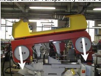
7. Снять пилу с колес.
