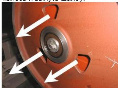
3. Снять колесо с вала с помощью съемника с тремя захватами. Если на валу остается подшипник, его также необходимо снять.
