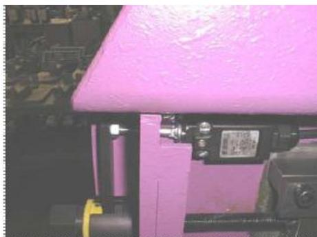
Устройство укомплектовано концевым выключателем. Внимательно и периодически проверять выключатель – время от времени регулировать.
