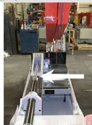
Установите раму пилы в положение 0° и после включения станка вводным выключателем нажмите кнопку обнуления угла (на распределительной коробке рядом с вводным выключателем). Размер угла зафиксирован.
