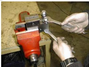
15. Заверните гайки на эксцентриках с помощью гаечных ключей.
