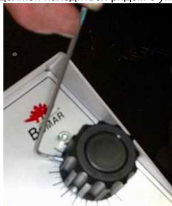
3. В ином случае необходимо ослабить червяк, поднять пластмассовую ручку и закрыть дроссельную заслонку до максимума. После чего ослабить червяк и снять пластмассовую крышку. Снова установить ее на место так, чтобы червяк находился рядом с упором при закрытой дроссельной заслонке. Снова затянуть червяк.
