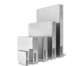
Колодки и инденторы для твердометров
