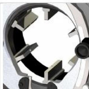
Концентрический зажим с 4 кулачками из нержавеющей стали для устранения деформации трубы
