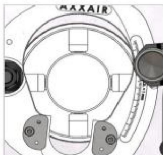
Концентрический зажим с 4 кулачками из нержавеющей стали для устранения деформации трубы
