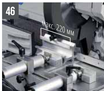
COBRA 352 NC 5.0 Специальные тиски для уменьшения длины остающегося прутка
