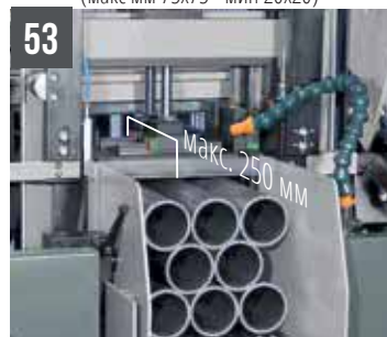
SHARK 230-1 NC HS 5.0 - Гидравлические вертикальные тиски для одновременной обработки нескольких заготовок (макс. 230x230 мм)
