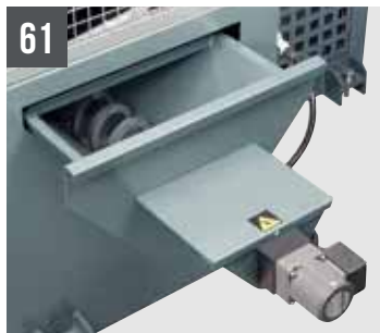
SHARK 230-1 / 331-1 NC 5.0 spider Моторизованный шнек для удаления стружки
