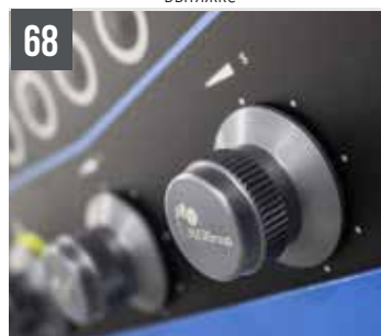
TIGER 352 NC 5.0 Скорость вращения диска 15÷150 Об./м - инвертер 5,5 кВт
