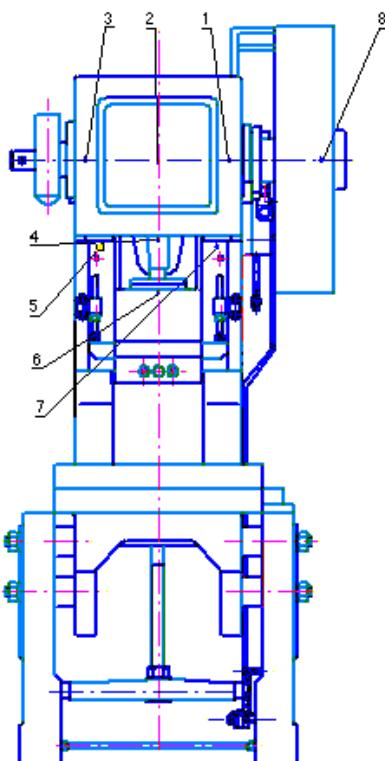
Перед началом работы пресса его следует полностью смазать, чтобы трения поверхность не нагревалась и не сцеплялась. Подробности см. в следующей таблице.
