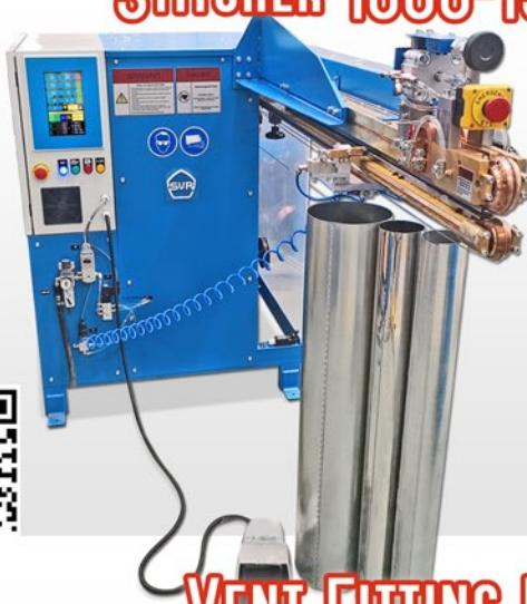
Сварка герметичного шва превосходного качества без повреждения гальванической поверхности со скоростью до 15 м/мин. Однаково упречная работа с оцинкованной, нержавеющей и «черной» сталью. Рабочий вылет до 1540 мм. Цветной 11" TouchScreen контроллер на базе Windows 10 с энергонезависимой памятью на 99 режимов сварки. Пневматический прижим верхнего ролика с электронным клапаном упрощает работу оператора, повышая производительность на 10-15%.
