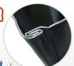
Станок предназначен для серийного производства прямоугольных воздуховодов. Формирование и осадка замка в один проход. Толщина стенки от 0,5 до 1,0 мм. Минимальное сечение короба 100x100 мм. Автопилот для фиксации заготовки. Возможность производства короба из двух L-образных половинок или из 4 полос металла. Автоматизация рабочего процесса и увеличение производительности. Возможна установка узла герметизации.
