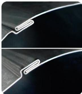
ки центрального, внутреннего и наружного фальца. Высокая рабочая скорость до 16 м/мин. Гидравлический прижим закрывающего ролика обеспечивает плотный герметичный замок. Минимальное сечение короба 70 x 95 мм.
