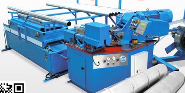
Спирально-навивной станок для производства стальных оболочек ППУ труб, балластных трубопроводов и ВЕНТИЛЯЦИИ. Единственный в отрасли станок работающий с штрипсами различной ширины: 137/ 140/ 150/ 205/ 215 мм. Экономия до 6% материала. На 40% меньше швов на трубы. Диапазон Ø: 80 - 2500 мм. Толщина металла: 0,4 - 2,5 мм. Производит трубы как с наружным, так и внутренним швом. Чистый рез трубы с толщиной стенки до 2,0 мм запатентованным слиттерным ножом. Нанесение ребра жесткости до 15 мм высотой.
