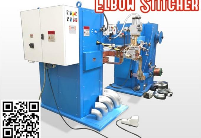
Пара станков Inner/Outer - для радиальной сварки штампованных отводов, состоящих из двух частей. Первый станок варит внутренний радиус отвода, второй - внешний. Диапазон Ø от 80 до 315 мм. Возможность работы с оцинкованной, нержавеющей и черной сталью. Электродом является медная проволока Ø 2.0 мм. В результате беспрерывного сварочного процесса получается герметичное соединение .
