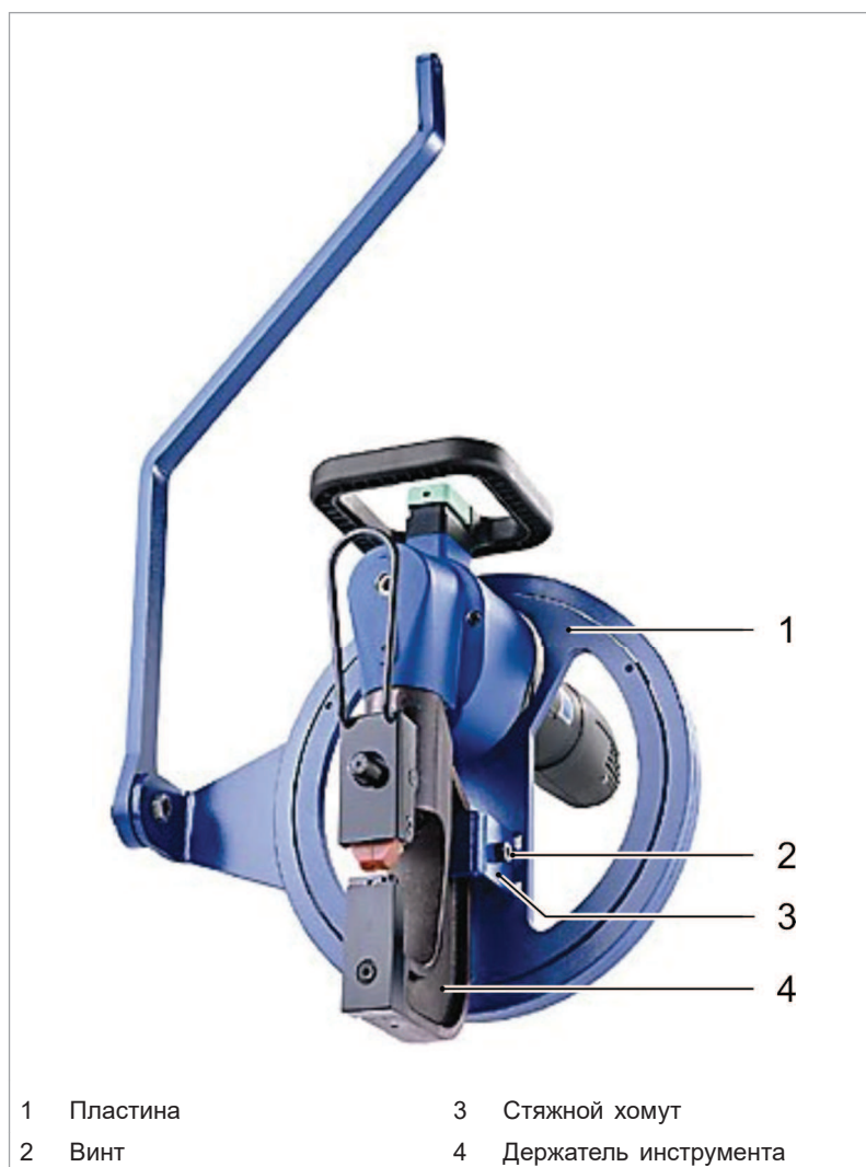
TruTool TF 350 с монтированным поворотным венцом
