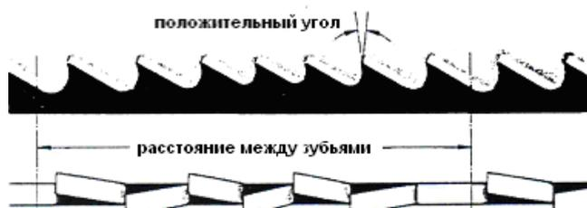
Этот тип полотна наиболее пригоден для резания сортового профиля и толстых труб, а также резания бруса при максимальной режущей способности. Применимый шаг: 3-4/4-6.
