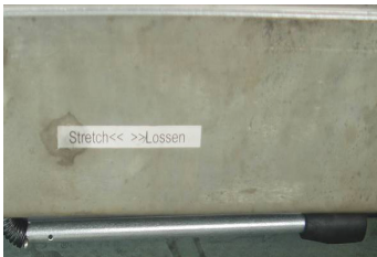
Рис. 8. Рычаг регулировки натяжения ремня
