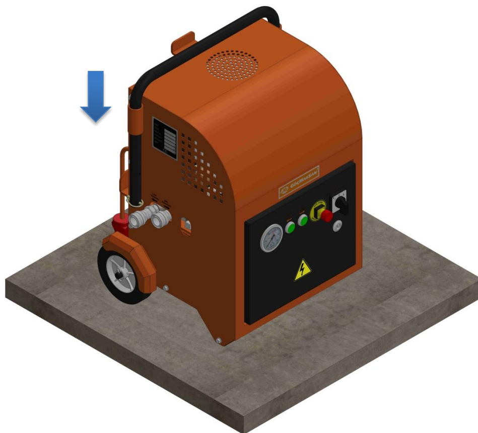
Рисунок 2. Выравнивание станка на твердом грунте
