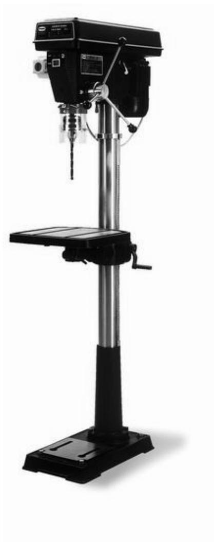
**СВЕРЛИЛЬНЫЙ СТАНОК НА СТОЙКЕ
