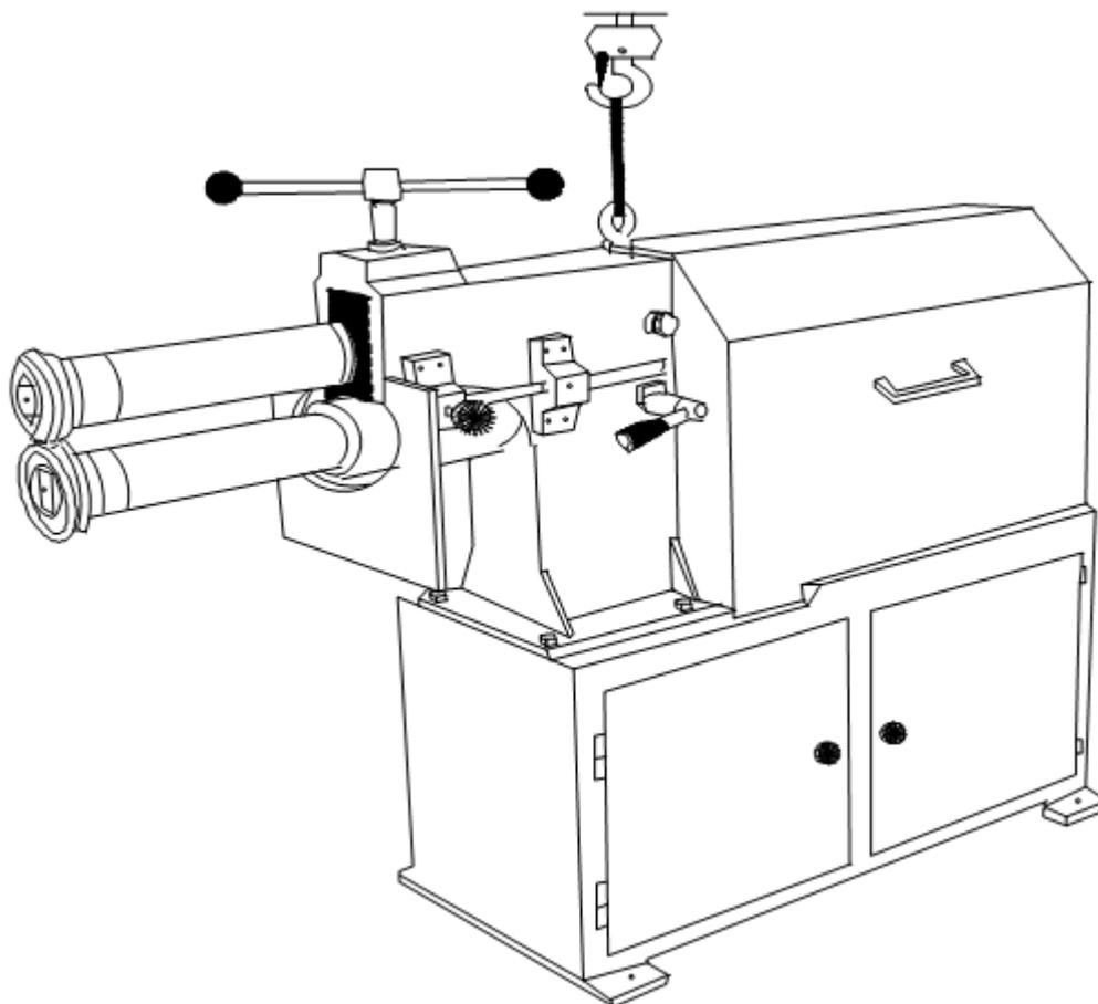
*Машину нужно нести с помощью подъемного крана как показано выше. Не поднимайте машину ни за какие части, кроме поднимающегося кольца.*
