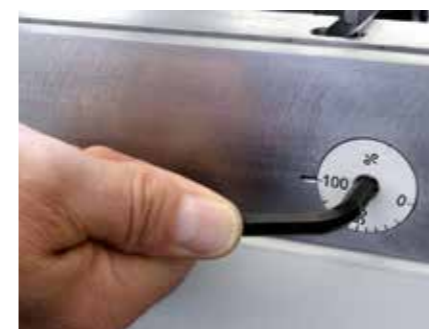
Настройка CrownTool для бомбирования инструмента гибочной траверсы.
