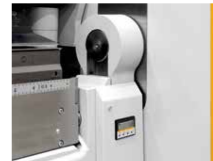
Дополнительная цифровая индикация для регулирования гибочной траверсы.
