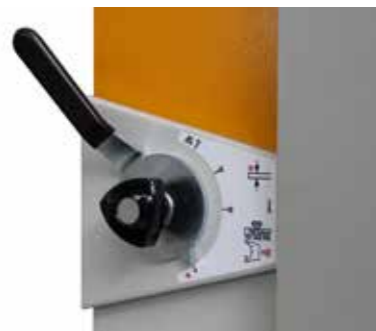
Рычаг для регулирования режущего зазора на PRIMEcut.
