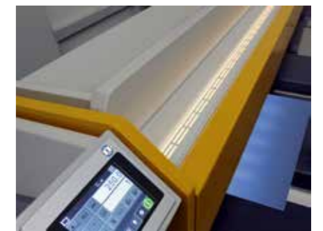
Удобное выравнивание заготовки по разметке при помощи светодиодного освещения режущего зазора.
