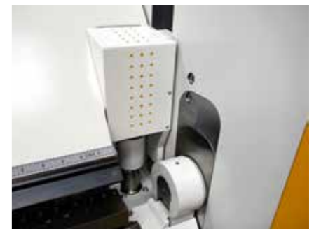
PowerBooster зажимают листы силой зажима в 120 тонн и обеспечивают ровную гибку.
