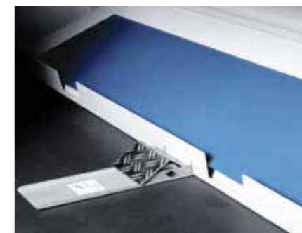
Педаля для системы сортировки нарезанных заготовок
