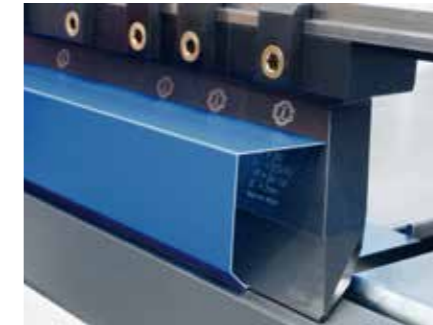
инструмент «козья ножка» со свободной зоной спереди
