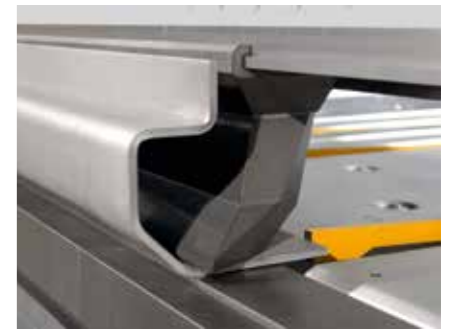
Инструмент прижимной траверсы с большим свободным пространством спереди.
