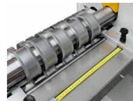
Мерная лента для быстрой предварительной настройки.
