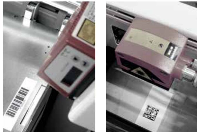
Автоматический вызов гибочной программы, при сканировании штрих-кода или QR-кода в процессе загрузки MiniFeeder или портала.
