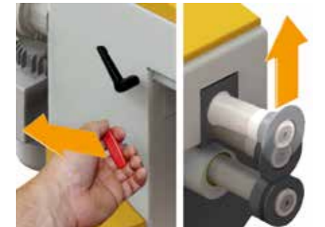
Функция UnLock раскрывает ролики в случае необходимости.
