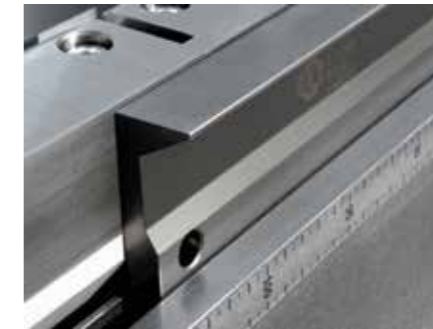
Тонкие, но стабильные инструменты гибочной траверсы дают большую свободу гибки деталей.
