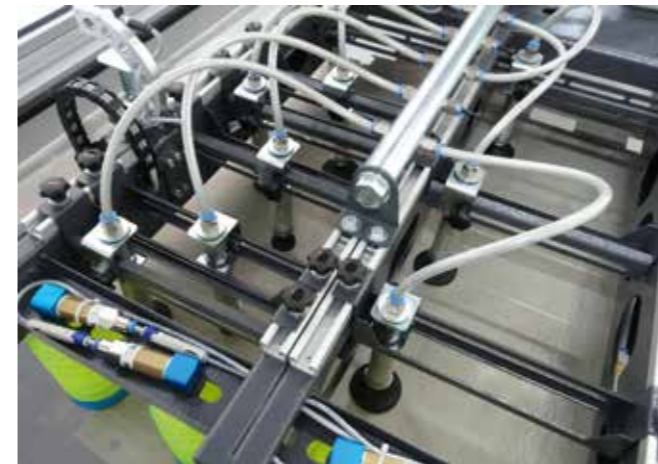
Всасывающая рама портальной загрузки с 6 предварительными и 45 свободно размещаемыми присосами.
