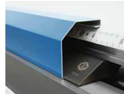
Прижимная траверса с острыми инструментами
