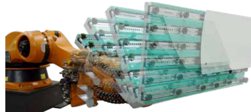
Подающий робот переворачивает заготовки
