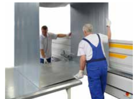
Для изготовления очень больших каналов нужны два оператора.
