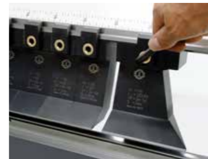
Инструменты с системой быстрого зажима
