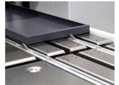
Гибочная деталь выравнивается по угловому упору.
