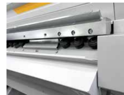
Для работ по техобслуживанию предусмотрены легко доступные формованные ролики.
