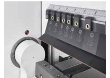
Лазер автоматически распознает точную высоту инструмента.
