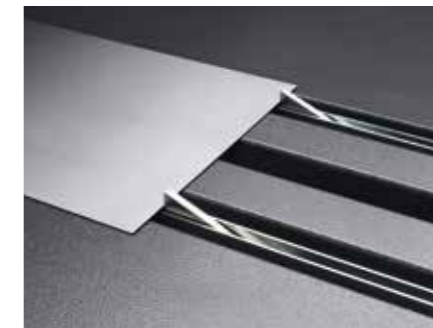
Точное позиционирование заготовки по пальцевым блокам заднего упора
