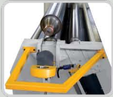
Hidrolik Üst Top Açma Kafası Hydraulic Drop-end ОТКИДНОЙ ТОРЕЦ С ГИДРАВЛИЧЕСКИМ ОТКРЫТИЕМ
