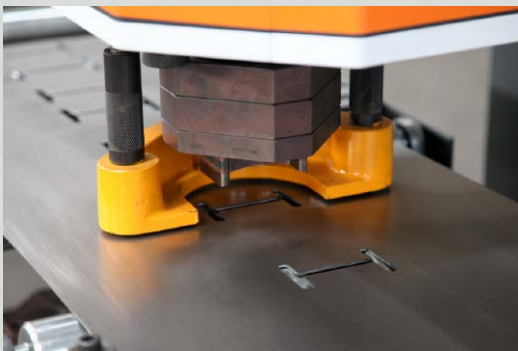
Özel sac delme aparatı Special sheet punching tool СПЕЦИАЛЬНЫЙ ИНСТРУМЕНТ ДЛЯ ПРОБИВКИ ЛИСТА
