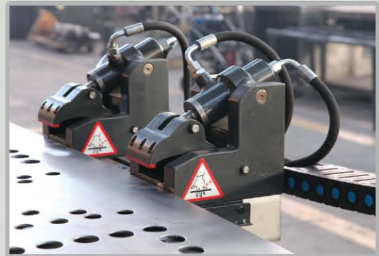
- Standart Hidrolik Sıkı malı Çeneler - Standard Material Holder With Hydraulic Clamps - ДЕРЖАТЕЛЬ С ГИДРАВЛИЧЕСКИМ ЗАХВАТОМ
