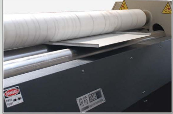
Kompozit Alucobond kıvrırmak için özel delrin kaplamalı üst mil Plastic coated top roll for bending Alucobond - composite СПЕЦИАЛЬНЫЕ НЕЙЛОНОВЫЕ РОЛИКИ ДЛЯ ГИБКИ АЛЮКАРБОНА
