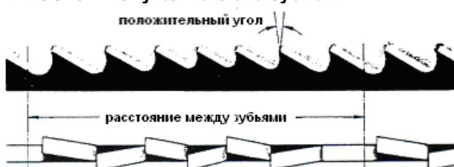
Этот тип полотна наиболее пригоден для резания сортового профиля и толстых труб, а также резания бруса при максимальной режущей способности. Применимый шаг: 3-4/4-6.
