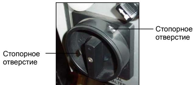
Главный соединительный переключатель имеет стопорное отверстие для предотвращения начала работы с целью обеспечения безопасности или несанкционированного доступа.
