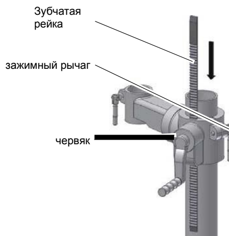
Рис.3-2: монтаж опоры стола
