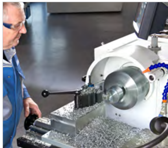
Электронный зажим суппорта: • исключено случайное смещение суппорта
