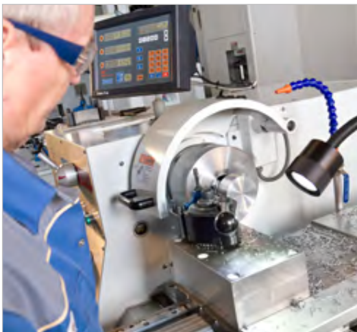
Точность и качество на уровне станков с ЧПУ: • торцовка с автоматически регулируемой постоянной скоростью резки
