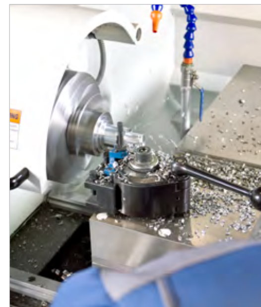
Равномерный ход при снятии толстой стружки (7 мм глубина резки (радиус) в 1.0721 стали для автоматической обработки)
