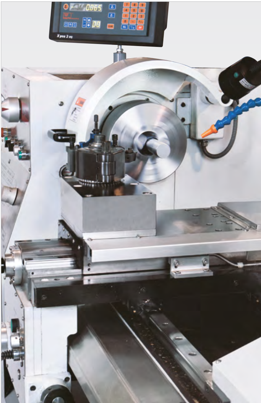
Линейные профильные направляющие по осям Z и X
