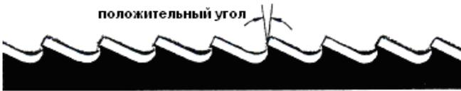
Может использоваться для поперечных и диагональных распилов различных сечений или широких труб, но основное применение – резка твердых материалов (высоколегированных и нержавеющей сталей, специальной бронзы и серого чугуна)
