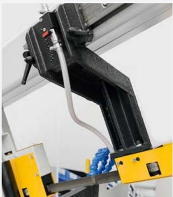
**Schwenkrahmenmaschinen mit 34er Sägebandbreite serienmäßig mit vertikaler Sägebandführung**
