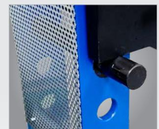
► *Einfache Tischhöhenverstellung mit Hilfe des Hydraulikzylinders und Befestigungsbolzens*
