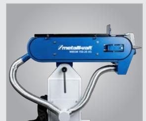
Absaugstutzen am Funkenkasten und an der hinteren Bandrolle
