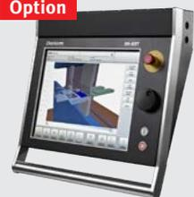
Die Steuerung Delem DA-69T ermöglicht neben den Funktionen der 66T die Programmierung der Produkte in 3D. Es können mehrere Arbeits- bzw. Werkzeugstationen eingerichtet werden. Der Bediener hat somit die ständige Kontrolle über die Lage und Orientierung des Werkstückes.
