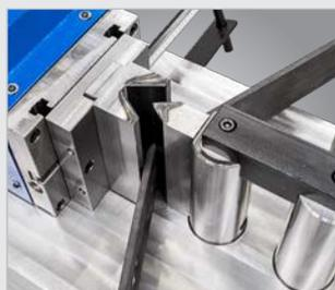
▶ Mit Schnellwechsellaufnahme und Seitenanschlag mit Skala
