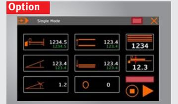
► **Optionale Steuerung Schneider NC2**, Dreischussteuerung für digitale Winkeleingabe, Eingabe der Hinteranschlagposition und Position der Oberwangenöffnung mit der Möglichkeit Kantfolgen zu speichern, motorischer Hinteranschlag mit Anschlagfingern, Verfahrbereich 15-1000mm
