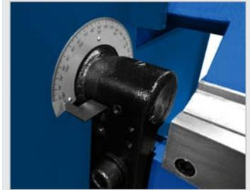
► einfache, manuelle Einstellung des Biegewinkels mittels Anschlag mit Skala
