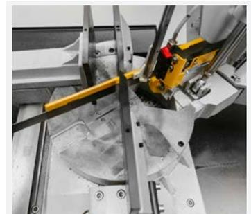
**Kugellagerter Drehteller mit zusätzlichen Verschleißplatten am Schnittspalt und 15° Rasterung**
