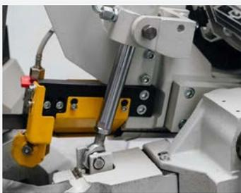
**Sägearmen am Zylindergehäuse montiert**
