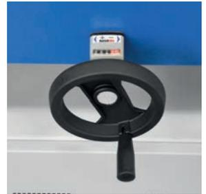
▶ Manuelle Höhenverstellung des Arbeitstisches mit Numerischer Anzeige
