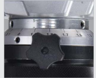
▶ Fasenbreite von 0 - 6 mm stufenlos einstellbar
