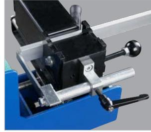
► Werkzeuglos verstellbarer Längenanschlag (nur bei 90°)
