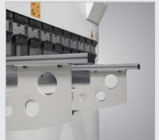
▶ Schnellverstellbare Frontauflagearme auf Linearschiene
