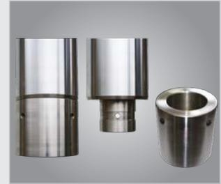
► Leicht zu wechselnde Stößelkappe für verschiedene Pressanwendungen.
