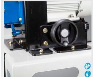
▶ Stufenlose Einstellung der Fasentiefe ohne Werkzeug möglich
