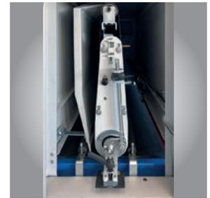
▶ Eine Schleifbandeinheit für die Oberflächenveredelung und zum Blankschleifen
