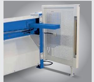
▶ Rückraum durch Lichtvorhang abgesichert
