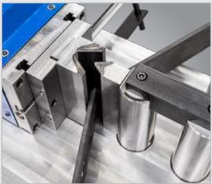
▶ Mit Schnellwechsellafnahme und Seitenanschlag mit Skala
