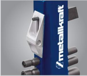
▶ Winkel zum Biegen von scharfen Kanten bei Flachmaterial
