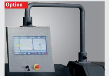
► **Optionale CNC-Steuerung mit 3D-Grafik**, die Profile werden vom Bediener auf einem großzügigem 19" Touchscreen gezeichnet, sämtliche Achspositionen und die Biegefolge werden von der Steuerung errechnet, motorischer Hinteranschlag mit Anschlagfingern, Verfahrbereich 15-1000 mm
