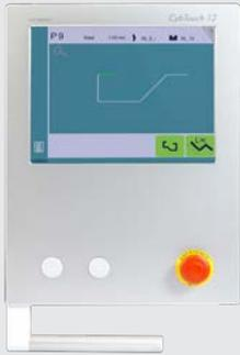
Bei der graphischen 2D-Steuerung CybTouch 12 mit Touchscreen werden die Produkte am Bildschirm gezeichnet – nachdem die Zeichnung erstellt ist, wird die Biegefolge graphisch festgelegt und die dazugehörigen Achspositionen automatisch errechnet werden.
