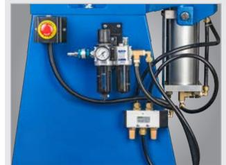
▶ Wartungseinheit für Pneumatik
