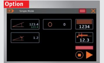
► **Optionale Steuerung Schneider NC1**, Biegewinkel, Hinteranschlag, und Oberwangenöffnung über Touchscreen, motorischer Hinteranschlag mit Anschlagfingern, 15-1000mm, Speichern von Kantfolgen möglich
