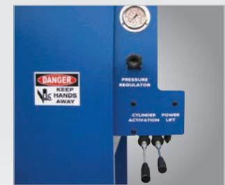
▶ Druckempfindliche Handhebel und Druckmanometer
