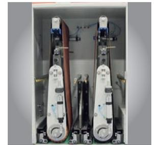
▶ Zwei Schleifbandeinheiten zum Entgraten und zur Oberflächenveredelung
