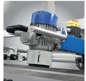
▶ *Optionale Entgratstation zum Entgraten und Polieren von flachen und gebogenen Bauteilen*
