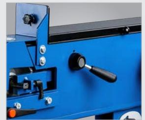
Sekundenschneller Schleifbandwechsel durch Schnellspannsystem
