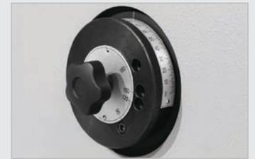
► **serienmäßige Steuerung MA** - manuelle Verstellung des Biegewinkels mittels Skalennring an der linken Maschinenseite
