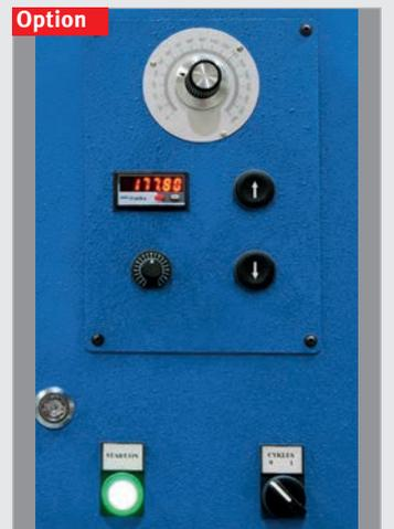
► **Optionale Steuerung PUD** mit Digitalanzeige, manuelle Verstellung des Biegewinkels und verstellbarer, motorischer Hinteranschlag
