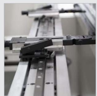
▶ Hinteranschlag X/R mit manuellen Z-Achsen
