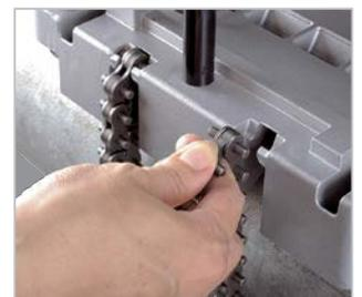
Halterung für Rohre mit einfachem Schnellspannsystem und Kette
