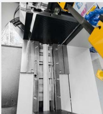
**Schwenkrahmenmaschinen mit 34er Sägebandbreite inklusive auswechselbaren Verschleißplatten am Materialauflagetisch**
