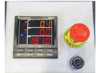
▶ Einfache Bedienung, mit digitaler Anzeige für aktuelle Biegewerte und zum Setzen der Parameter
