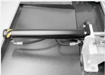
**Langhubzylinder an beiden Spannstöcken**
