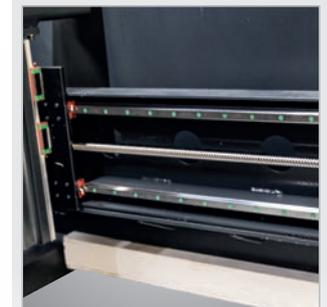
▶ Die über Kugelumlaufspindeln angetriebene X-Achse läuft auf doppelter Linearführung
