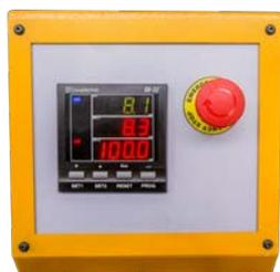
▶ Bedienpult mit Digitalanzeige und NOT-AUS Schalter
