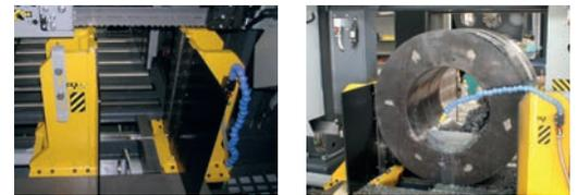
► Klemmung des Materials vor und hinter dem Schnitt durch zweigeteilten Schraubstock
