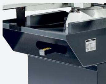
Spannhebel für Winkelverstellung von vorne
