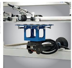
▶ *Werkstückspannung über Vakuumspannvorrichtung*
