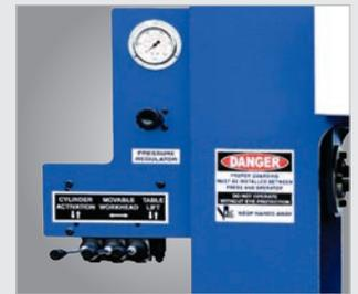
▶ Druckempfindliche Handhebel und Druckmanometer
