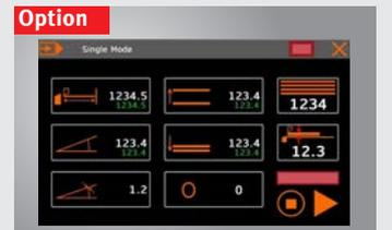
► **Optionale Steuerung Schneider NC2**, Dreiachssteuerung für digitale Winkeleingabe, Eingabe der Hinteranschlagposition und Position der Oberwangenöffnung mit der Möglichkeit Kantfolgen zu speichern, motorischer Hinteranschlag mit Anschlagfingern, Verfahrbereich 15-1000mm
