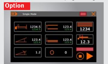
► **Optionale Steuerung Schneider NC2**, Dreiachssteuerung für digitale Winkeleingabe, Eingabe der Hinteranschlagposition und Position der Oberwangenöffnung mit der Möglichkeit Kantfolgen zu speichern, motorischer Hinteranschlag mit Anschlagfingern, Verfahrbereich 15-1000mm
