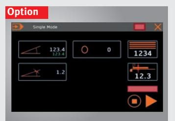
► **Optionale Steuerung Schneider NC1**, Biegewinkel, Hinteranschlag, und Oberwangenöffnung über Touchscreen, motorischer Hinteranschlag mit Anschlagfingern, 15-1000mm, Speichern von Kantfolgen möglich
