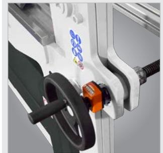
▶ Verstellung des Hinteranschlags über Handrad mit Zählwerk
