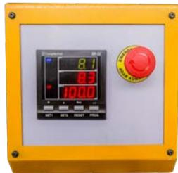
▶ Bedienpult mit Digitalanzeige und NOT-AUS-Schalter
