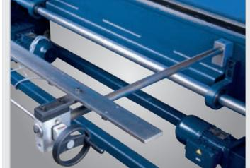
► Hinteranschlag mit Handrad und Messeinrichtung
