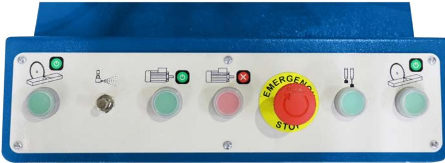
Bedienelemente von links nach rechts: Sägen Start Schalter links, Dosierbare Minimalmengenschmierung, Motor EIN, Motor AUS, NOT-AUS, Spannen, Sägen Start Schalter rechts
