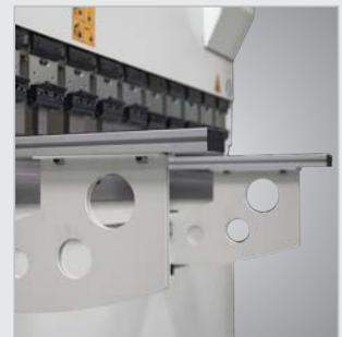
▶ Schnellverstellbare Frontauflagearme auf Linearschiene
