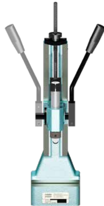
Handhebel umsteckbar für Links- oder Rechtshänder
