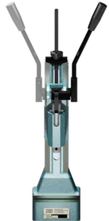
Handhebel umsteckbar für Links- oder Rechtshänder
