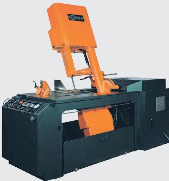
Данные станки предназначены для резки плит, труб, профилей под различными углами. Рама передвигается при помощи гидроцилиндра. Привод пильного полотна осуществляется гидромотором. Дополнительно к базовой комплектации к станку могут поставляться механические либо гидравлические тиски, вертикальные прижимы и роляганги.
