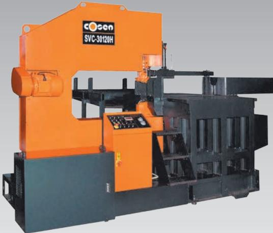
Станки серии SVC отличаются повышенной жёсткостью станины. Пильная рама приводится в движение сервомотором, либо гидроцилиндром, и движется при помощи ШВП по линейным направляющим. Главным преимуществом этих станков является резка широких и достаточно высоких плит при использовании пильных полотен относительно небольшой ширины. При необходимости на эти станки могут дополнительно устанавливаться роликовые столы, гидравлические тиски и вертикальные прижимы для позиционирования заготовки.
