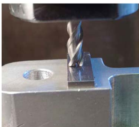
Рисунок 6.6 – Концевая фреза в предуснавливаемом держателе
