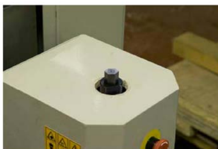
Снимок 2 – Стяжной болт
