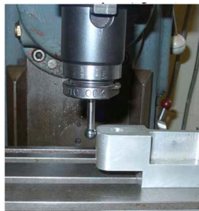
Рисунок 6.12 - Используемый инструмент для обнаружения кромок на фрезе
