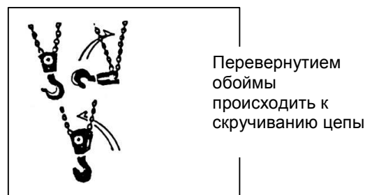
рис.2 перекрученную цеп необходимо выровнять
